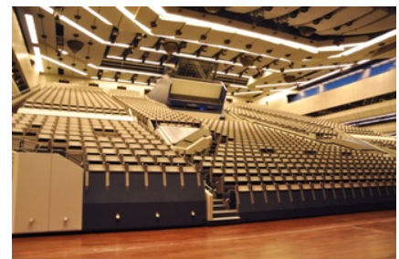
1,480名が着席できる観客スタンドがリフトアップして天井に姿を変える、ユニークな可変式の仕掛けを持つ「Hall 2」
